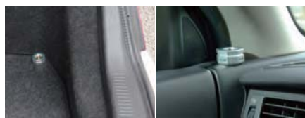
車内に配置する場所としては、高い位置としてはAピラーとCピラー付け根部あたり。低い位置としては車内のフロア四隅あたりが基本。
